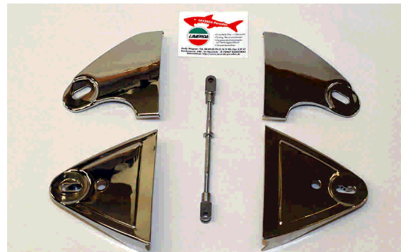
Bild 21: Lampenhalterausleger 750 + 1000/1200-180° und neues Bremsgestänge mit links-rechts Gewinde
