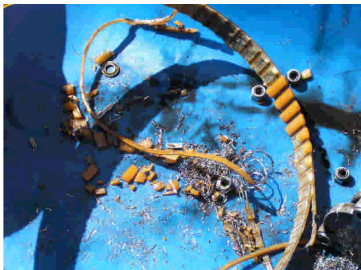
Bild 19: Nicht nur Zahnausfall, das Drahtgeflecht zerstörte den gesamten Dreizylindermotor des Franzosen
